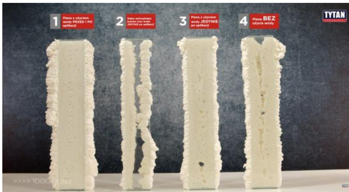
Rys. 36. Kadr z filmu przedstawiający prawidłową aplikację piany poliuretanowej Tytan Professional
