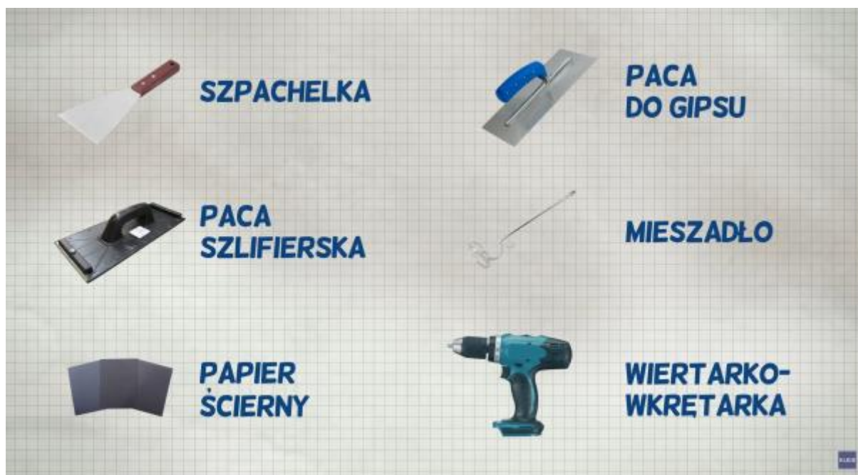
Rys. 33. Kadr z filmu przedstawiający uzupełnianie ubytków w ścianach podczas remontu
